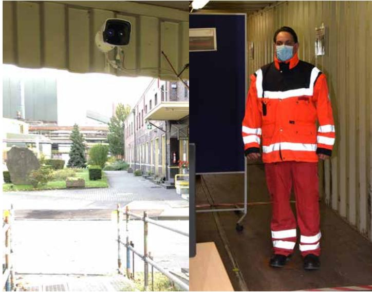
Die Kamera am Ende der Körpertemperatur-Messschleuse misst vor Arbeitsantritt die Temperatur jedes Mitarbeitenden – kontaktlos.
